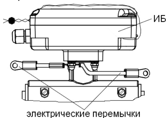
Рис.9. Электрические перемычки на ИБ расходомера.
